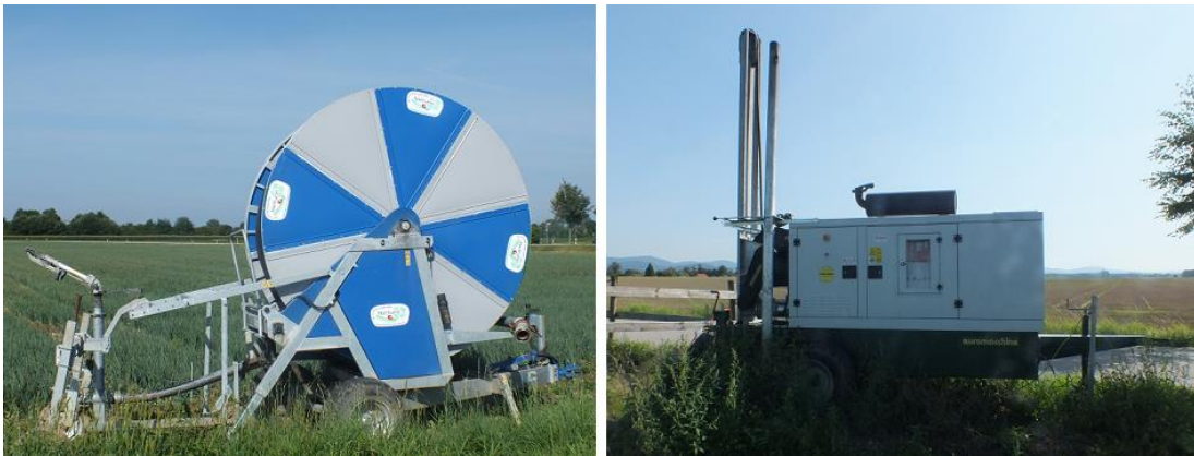
Abbildung 3: Beregnungsmaschine (links) und Pumpaggregat (rechts)
