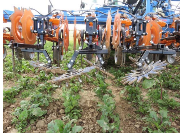
Abbildung 6: Fingerhacken (Schmotzer) beim Einsatz in Roter Bete 2018
