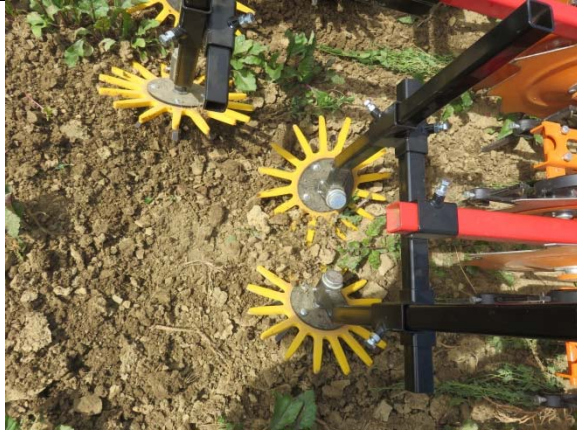
Abbildung 5: Fingerhacken (K.U.L.T.) beim Einsatz in Roter Bete 2018
