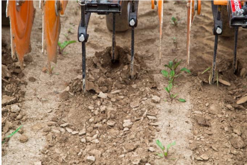
Abbildung 3: Gänsefußschare beim Einsatz in Roter Bete
