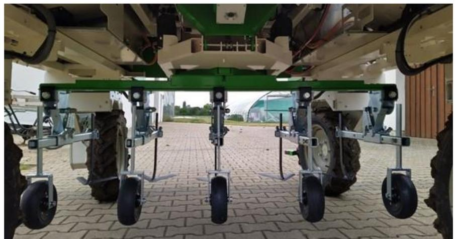
Bild 2: Fest verbauter Werkzeugträger mit einzeln abnehmbaren Parallelogrammen
