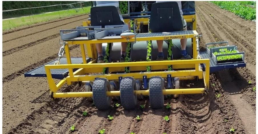
Bild 1: Aufzeichnung der Fahrspur mit der Antenne des Roboters auf der Pflanzmaschine
