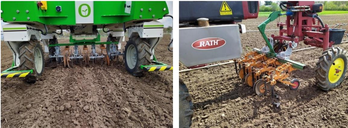
Bild 4: links: Gänsefußschare und Hackschutzrollen am Roboter; rechts: Die gleichen Werkzeuge an einem konventionellen Geräteträger
