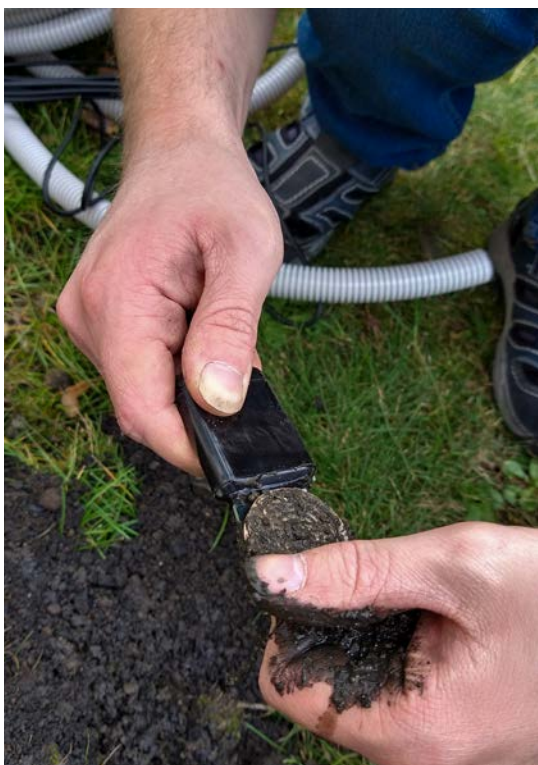
Einbau eines Sensors zur Messung des Boden-Matrix-Potenzials.
