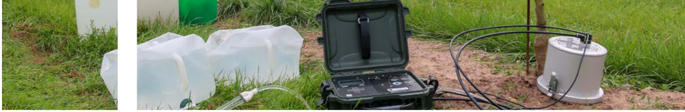
Automatisierte Bestimmung der gesättigten Wasserleitfähigkeit mit Dual-Head-Infiltrrometer 1.
