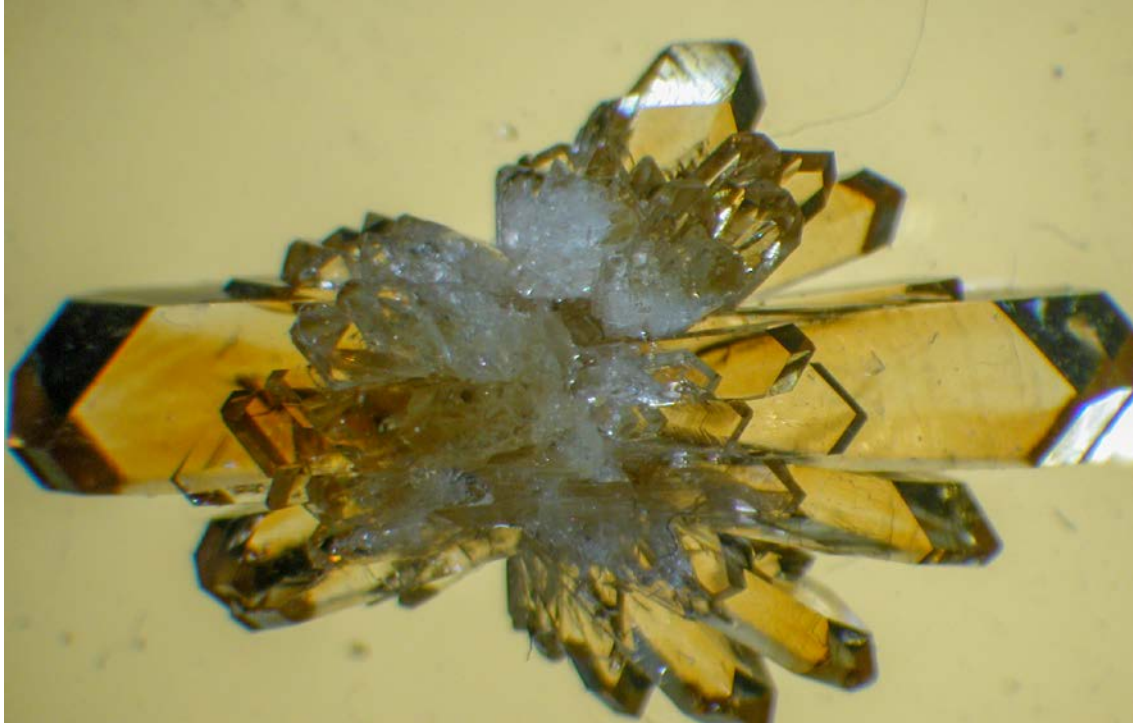
Mikroskopische Aufnahme eines Kalium-Hydrogen-Tartrat-Kristalles, der bei der Lagerung bei unzureichender Stabilisierung ausfallen kann. Der Kristall ist weinfarben.
