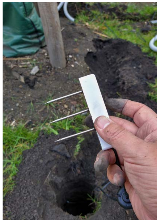
Einbau eines Sensors zur Messung der Bodenfeuchte.
