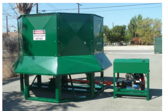
Abbildung 2: SIS-Gerät - Beim Einsatz wird die Kaltluft von unten angesaugt und nach oben ausgeworfen.
