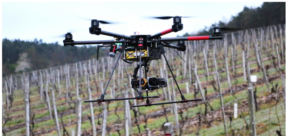
Abbildung 5: Drohne mit Infrarotkamera zur Bestimmung der Oberflächentemperatur des Bodens
