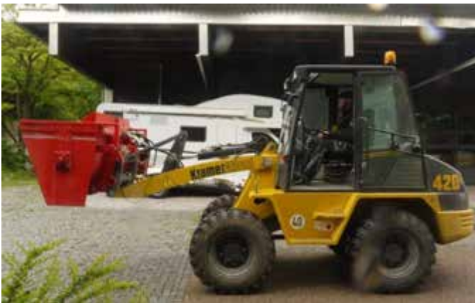
Abbildung 24: Versuchsbaummaschine. Radlader von Kramer 420, Baujahr 2001.
