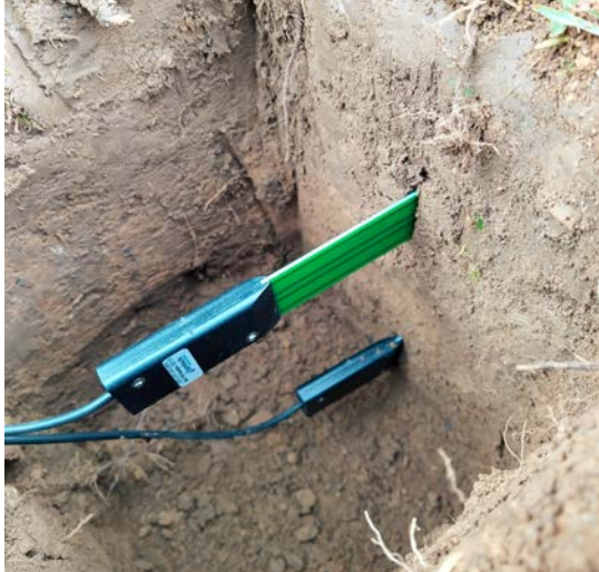
Bodenfeuchtesensoren erlauben eine Überprüfung der Empfehlungen der Bewässerungs-App.
