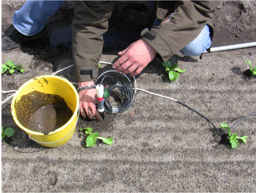
Abbildung 3: Tensiometer mit Verlängerungskabel im Knoblauchsland
