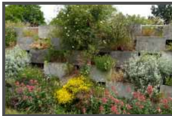
Bild 3: Beim System "Heinzmann" ist während der gesamten Versuchsdauer viel Betonfläche zu sehen.
