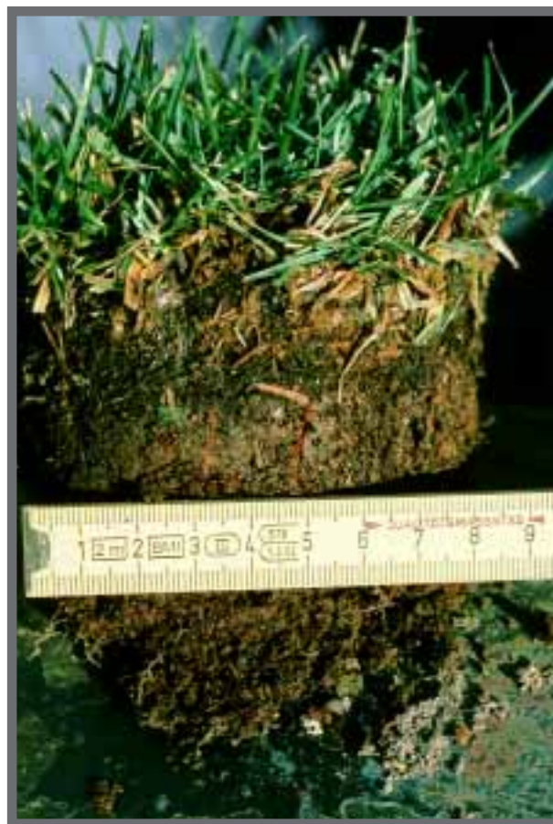
Bild 9: Lehmige, humose Rasentragsschicht, Bodengruppe 6
