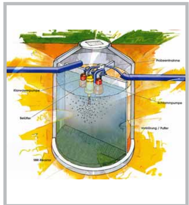
Abb.12: SBR-Anlage. Die Bakterien zur Abwasserreinigung werden frei schwimmend mit Sauerstoff versorgt, so dass auf ein Festbett verzichtet werden kann. Werkfoto
