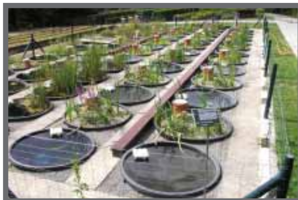
Bild 1: Die Versuchsanlage ist so aufgebaut, dass sie einen direkten Vergleich der eingesetzten Substrate ermöglicht.
