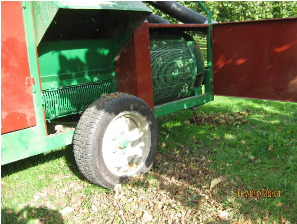
Abbildung 9: Vollernter mit „husk remover“ im Einsatz
