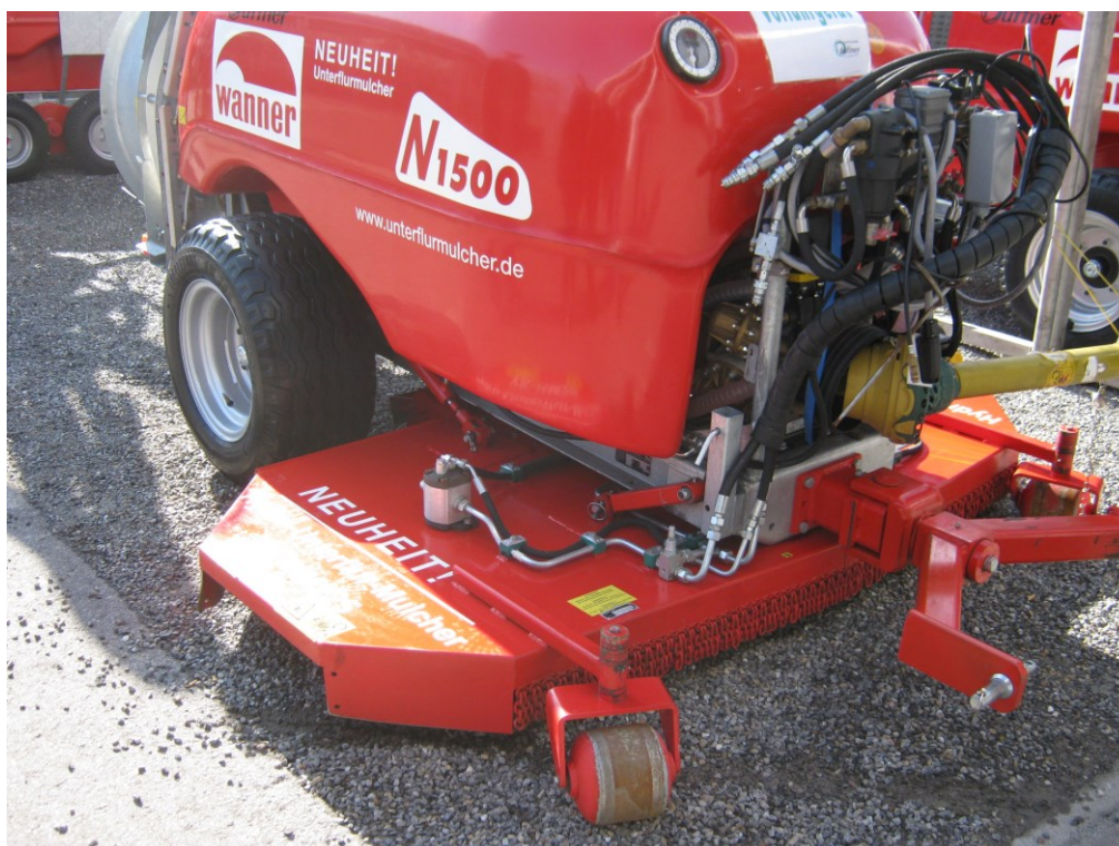
Abbildung 14: Gebläsespritze mit integriertem Mulcher
