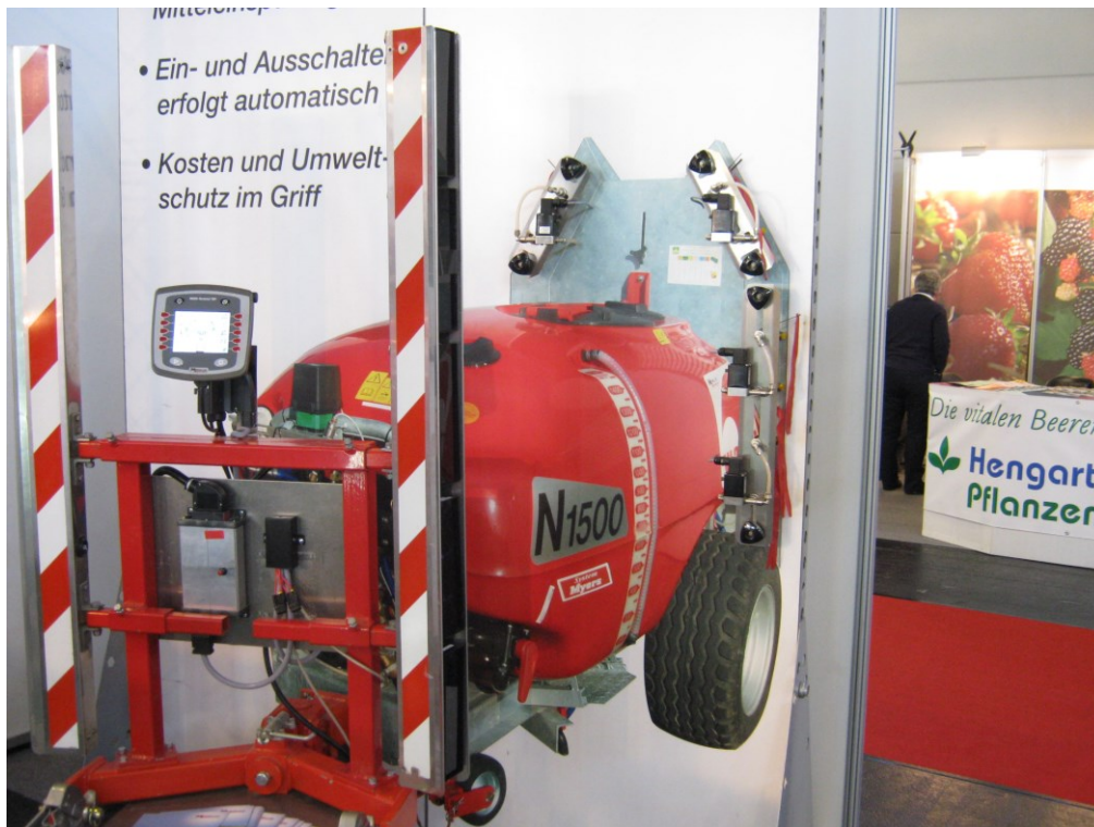
Abbildung 13: Gebläsespritze mit automatischer Baumerkennung
