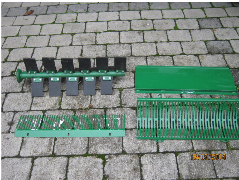
Abbildung 8: Umbausatz „husk remover“ (Facma)
