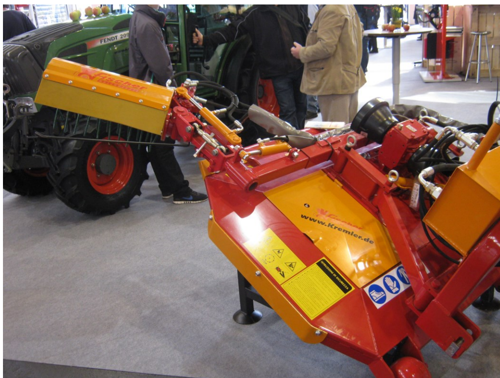
Abbildung 16: Mulchgerät mit Ausleger (Reihe + Gasse)
