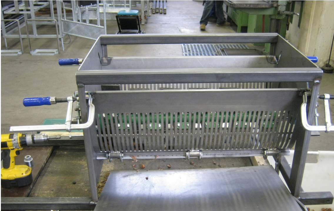
Abbildung 12: Fruchtblatthüllen Entferner (unfertiger Prototyp)
