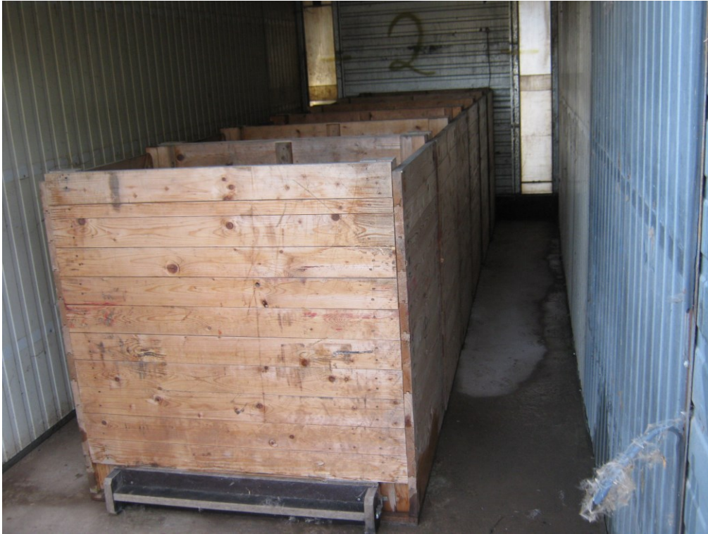
Abbildung 3: Kistentrocknung im Trocknungsofen
