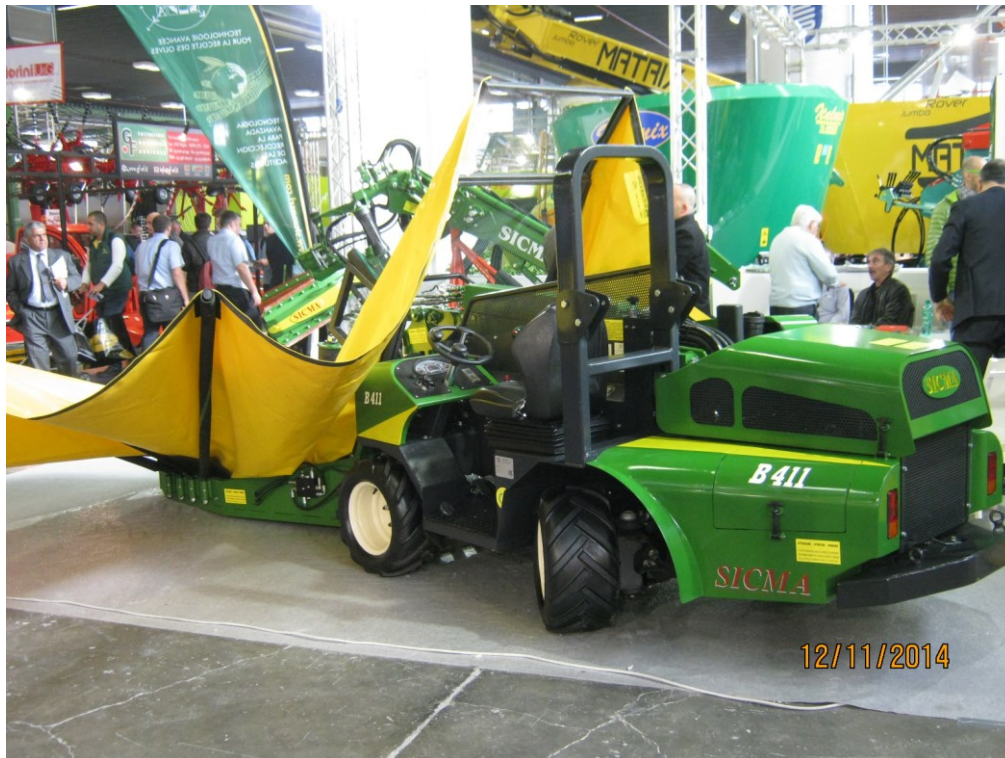
Abbildung 21: Olivenvollernter mit Faltschirm und Schüttler (Sicma)
