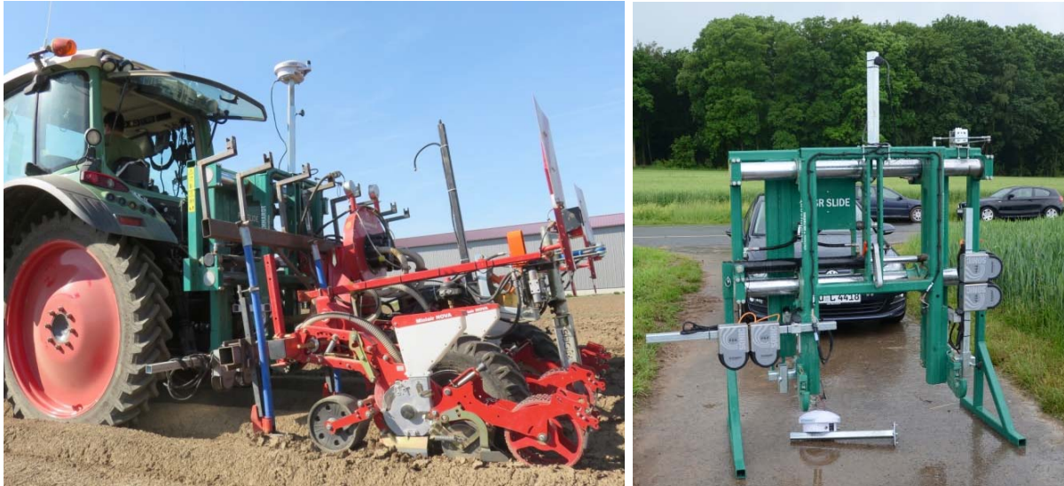
Abbildung 13: Reichardt Verschieberahmen mit Ultraschallsensoren und GPS-RTK Empfänger
