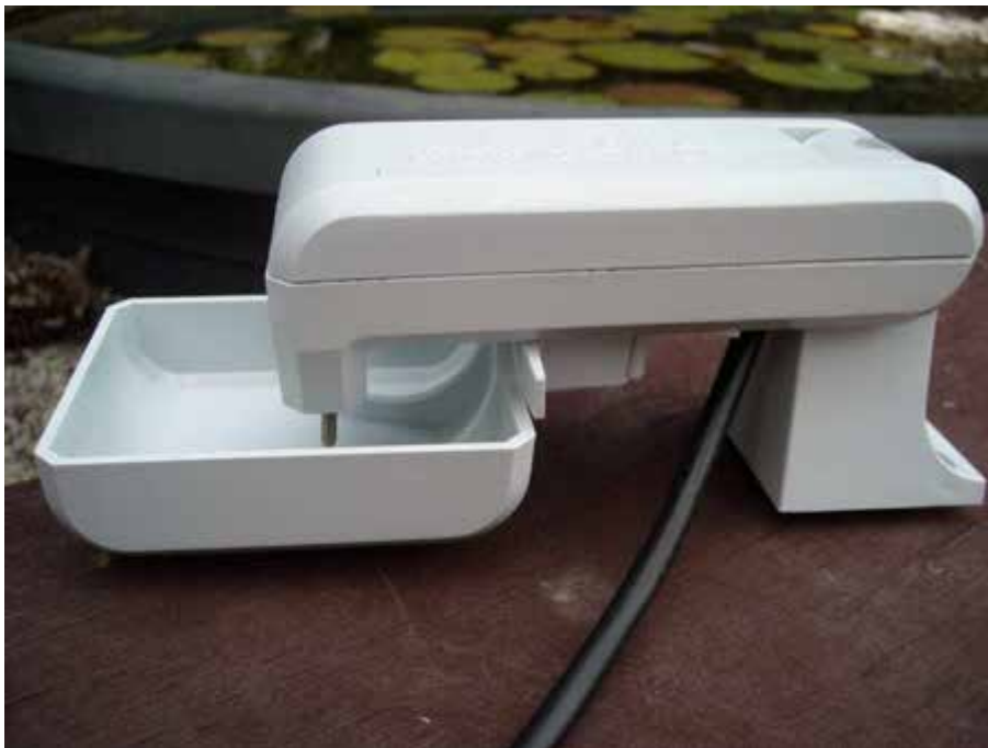
Abbildung 8: Rain-Check, elektronische Beregnungs-Abschaltautomatik der Firma Rainbird an den Versuchspartellen des Zedernhains (Parzellen 2-5)
