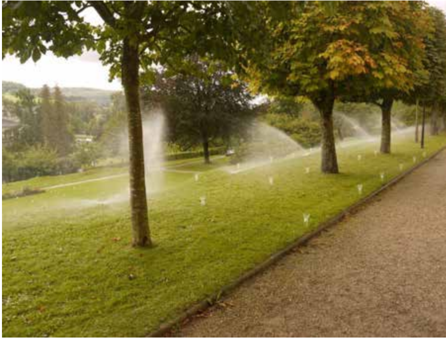
Abbildung 14: Messung der Gleichmäßigkeit der Wasserverteilung am Fürstenhof.
