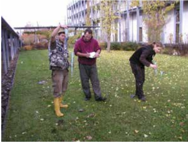
Abbildung 13: Messung der Gleichmäßigkeit der Wasserverteilung nach DIN EN 12484-5 als Kriterium bei der Abnahme.
