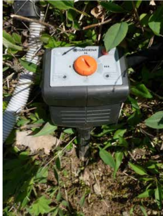
Abbildung 7: Bodenfeuchtefühler der Firma Gardena im Bewässerungsversuch (Parzelle 15)
