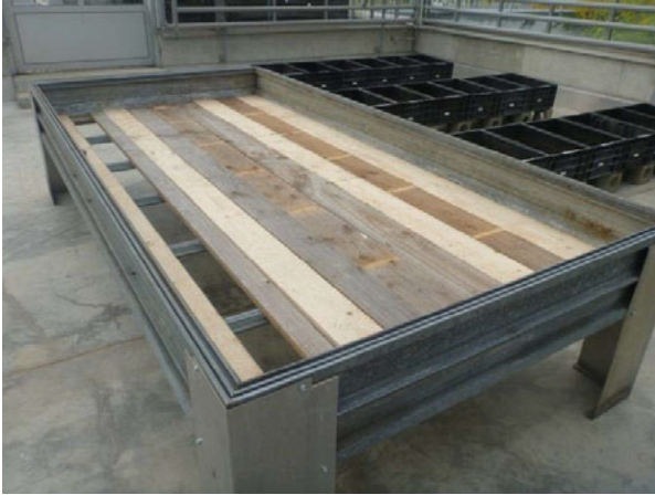
Bild 7 Dachmodell mit Holzbrettern
