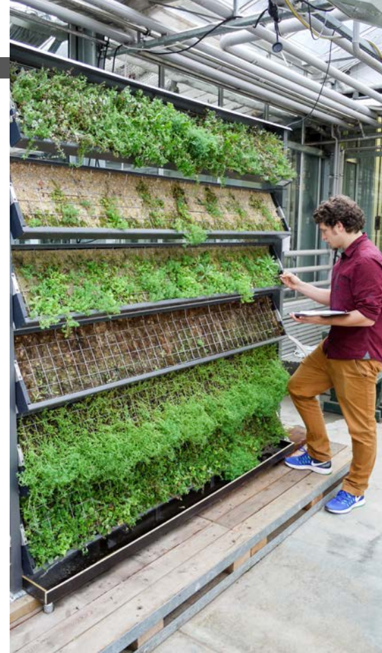
Bild 3: Das begrünbare, drehbare Lamellensystem als Versuchsobjekt: Verschiedene Trag- und Speicherschichtmaterialien in Kombination mit Vegetationsmatten und Ansaaten.
