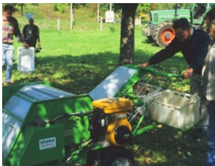
Bild 7: Obstwiesel OW 85 von Bäuerle bei einer Maschinenvorführung; das Obst wird in Kisten weggetragen.
