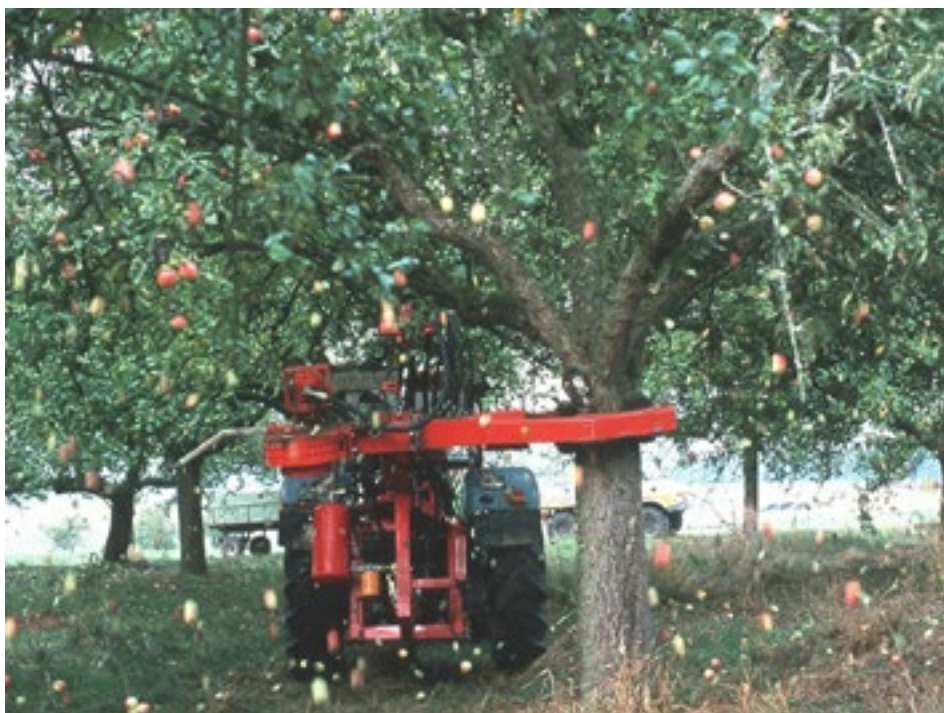
Bild 3: Der Hydraulikschüttler HSA-10 von LIPCO im Einsatz.
