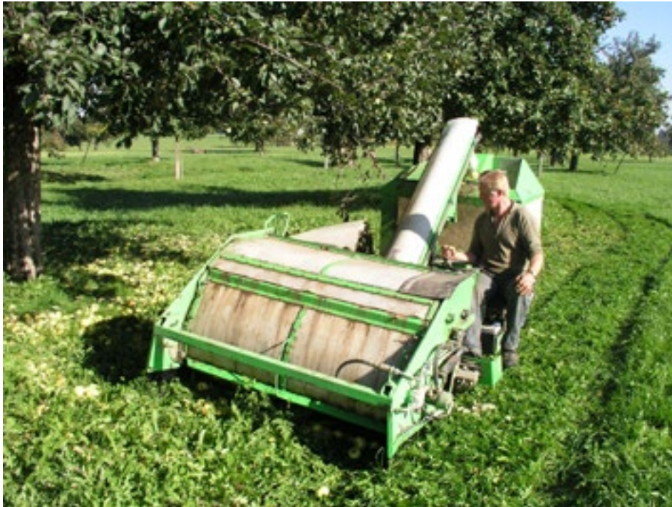
Bild 9: Das Obstwiesel SF II von Bäuerle kann nur in großen, gleichmäßig gestalteten Streuobstwiesen rentabel eingesetzt werden.
