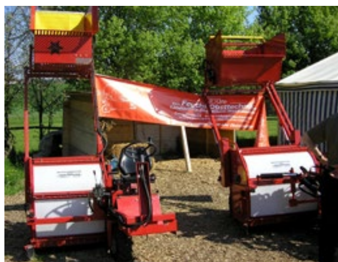
Bild 8: Die Aufsitzgeräte OB 80R (links) und OB 100 A von Feucht können den Bunkerinhalt auf den Hänger kippen, Entladehöhe bis 2,65 m.
