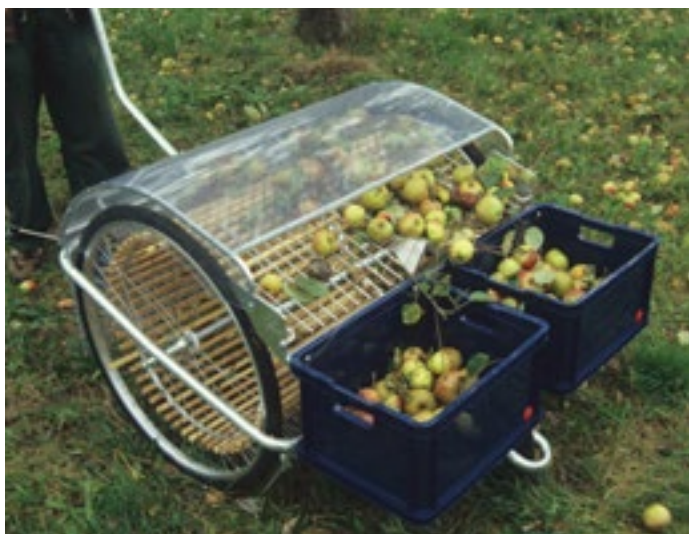
Bild 5: Der Obstigel® HWO – 01 ist kinderleicht zu schieben; maschinell aufgelesenes Obst muss noch nachgereinigt werden.
