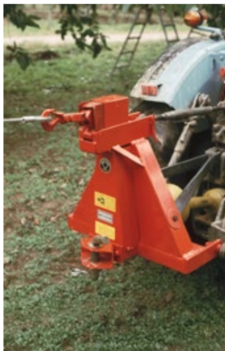
Bild 2: Der Seilschüttler von Harter, am Heck des Schleppers angebaut.
