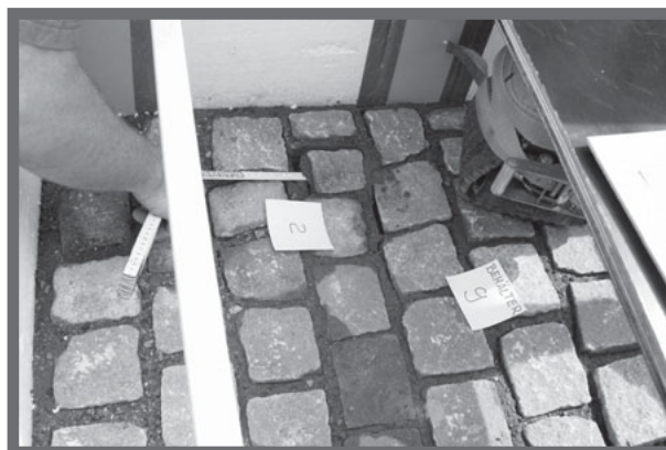
Bild 4: Wehe, wenn bei Wassersättigung geparkt wird! Bettung und Fugenfüllung nach FLL halten der Belastung nicht Stand.
