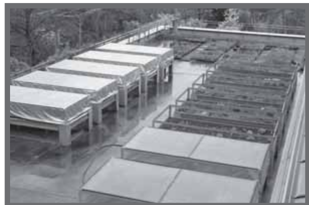
Bild 1: Blick auf die Versuchsanlage. Auf der linken Seite befinden sich die Behälter mit dem 60%-Schattiergerüst.
