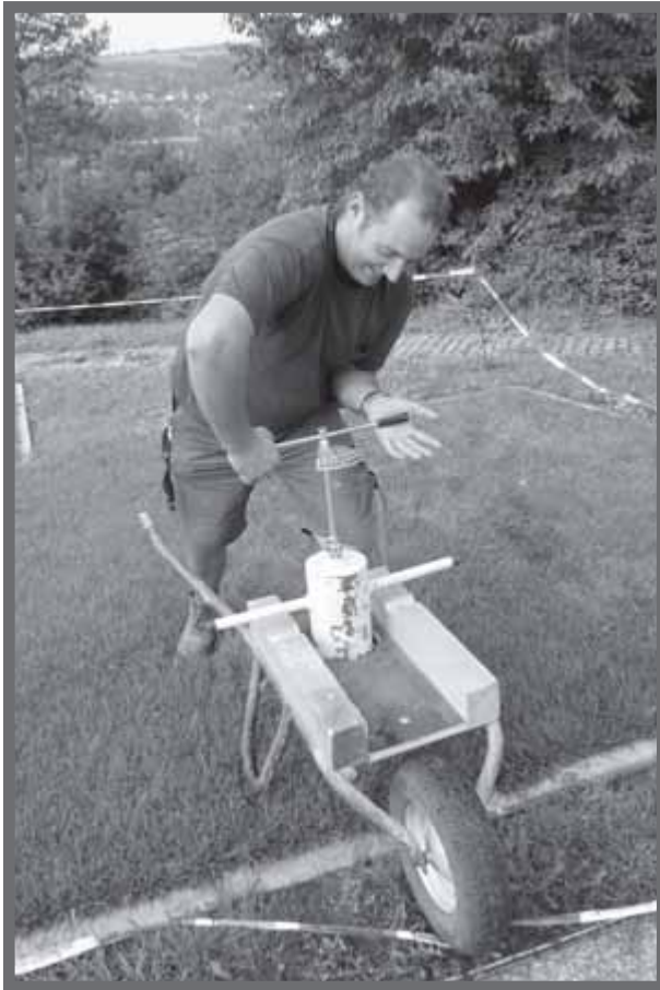
Bild 2: Bestimmung der relativen Scherfestigkeit mit Drehmomentschlüssel und einem zylindrischen Gewicht von 75 kg, das mit Stollen bewehrt ist.
