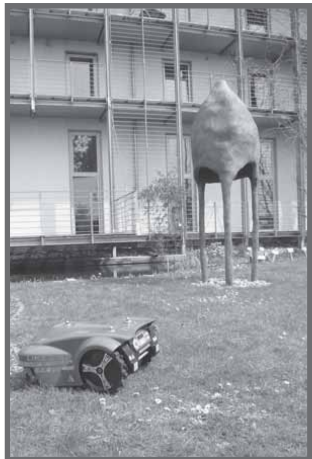
Bild 1: Ein Ambrogio-Roboter mäht nach dem Zufallsprinzip den Rasen und folgt einer Induktionsschleife zur Ladestation.
