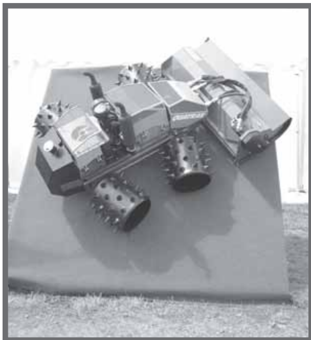
Bild 3: Funkgesteuerte Geräteträger erhöhen die Arbeitssicherheit im steilen Gelände.
