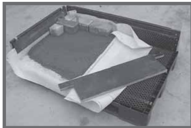
Bild 2: Aufbau der Prüfpärzellen (Rahmen zu Demonstrationszwecken geöffnet).
