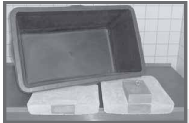
Bild 1: Versuchsaufbau mit Kunststoffbehälter und standardisiertem Einbau des zementgebundenen Schutzschichtmaterials.
