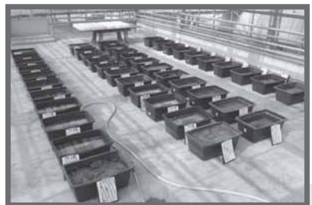
Bild 2: Blick über die Versuchsanlage 5 bzw. 6 Wochen nach der Inbetriebnahme; vorausgegangen ist eine 14 tägige Abbindezeit mit Betonnachbehandlung und anschließender Befüllung mit Leitungswasser.
