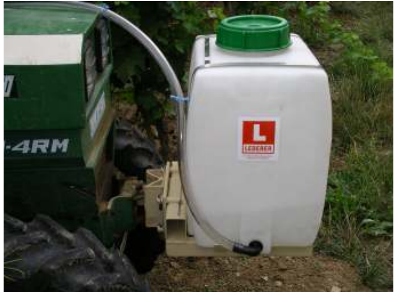
Abb. 3: Zusatzwassertank mit Universalanbaubock (Fa. Lederer) zum schnellen An- und Abbau. (Bild Hofmann, LWG)
