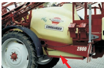
Zusatzwassertank am Feldspritzgerät
