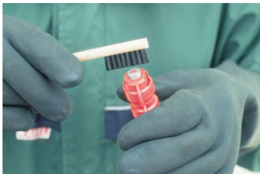
Düsenreinigung: Reinigung nur mit weicher Bürste
