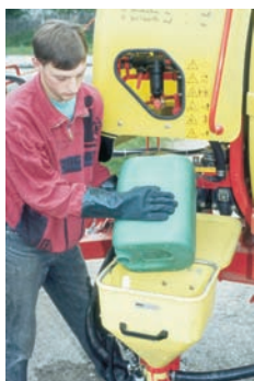
Kanisterspülung bei Feldspritzgerät (Reinigungsdüse in Einfüllschleuse eingebaut)
