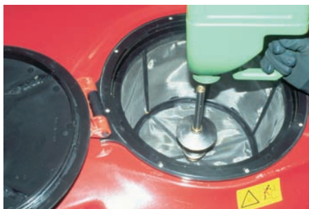
Kanisterspülung am Sprüngerät (Reinigungsdüse im Einfülldom eingebaut)
