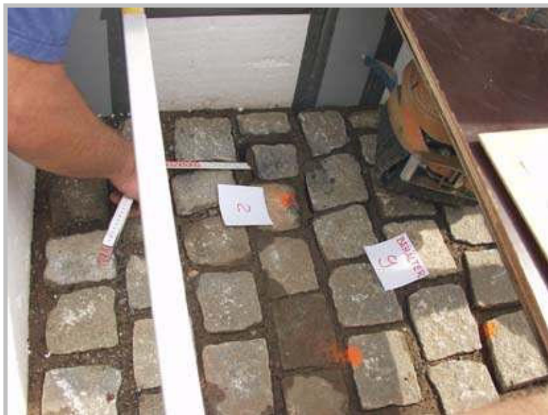
Probleme bei Belastung: Begrünbare Fugenfüllung und Bettung nach FLL-Rezeptur bei Scherversuchen im wassergesättigten Zustand
