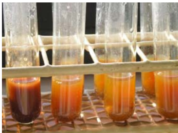
Abbildung A 4.3: Bitterstoffgehalt bei Lupinen: Linkes Reagenzröhrchen bitterstoffhaltig, die drei anderen Reagenzröhrchen bitterstofffrei
