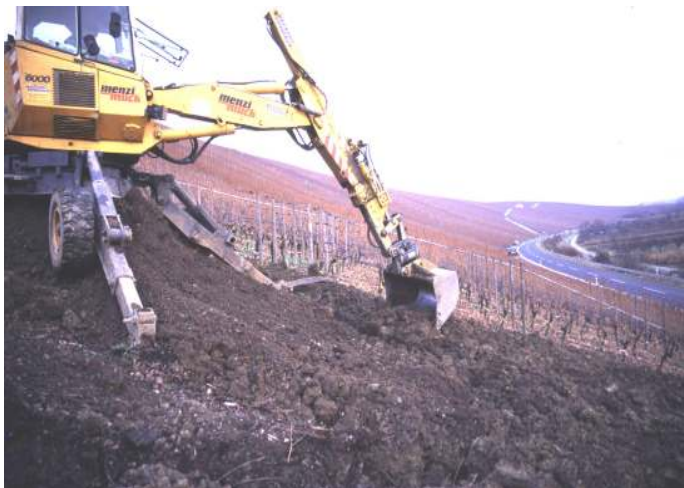
Abb. 2: Rigolen am Steilhang mit dem Stelzenbagger
