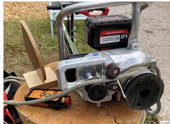
5 Spillwinde SP1000 mit Funkfernbedienung Foto: S. Geßler, LWF
