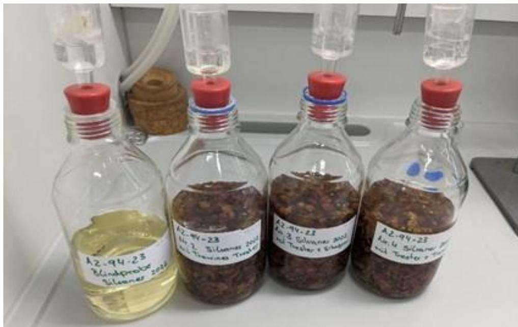
Bild 8: Versuchsansatz der Tresterextraktion mit Wein.
