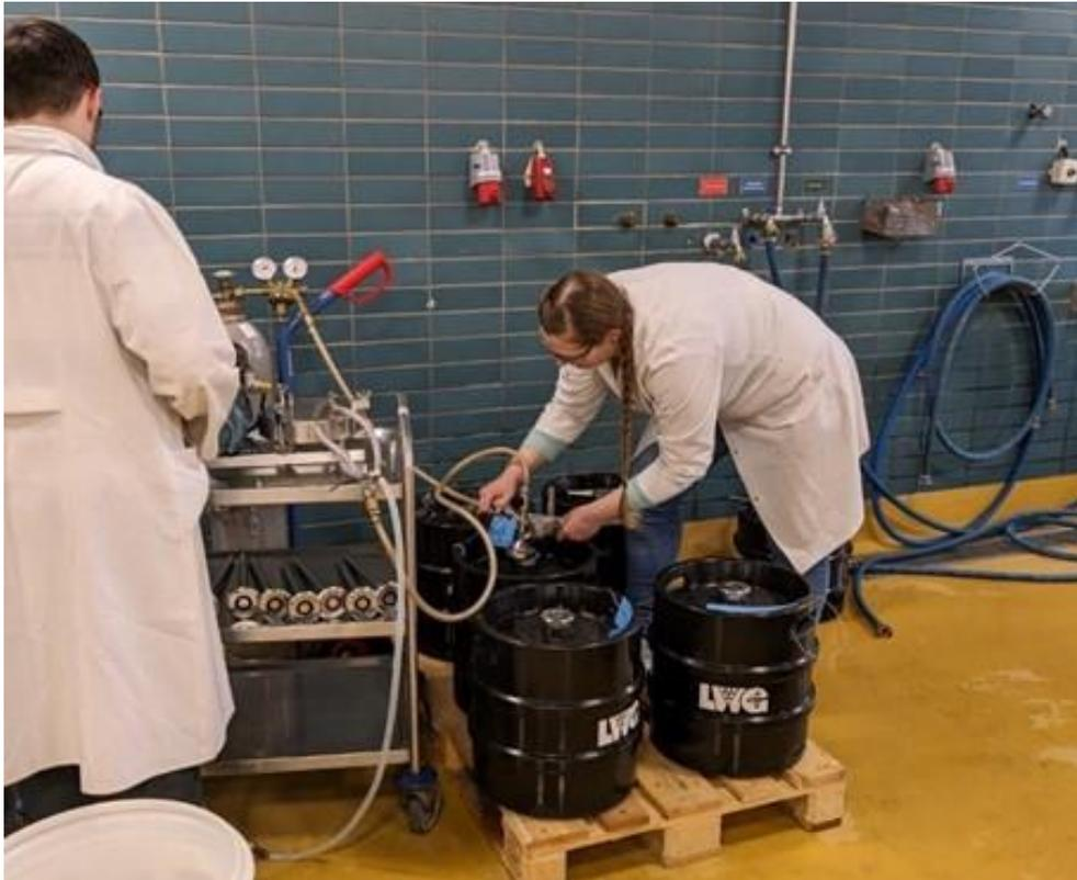
*Bild 7: Filtration der Versuchsansätze.*
