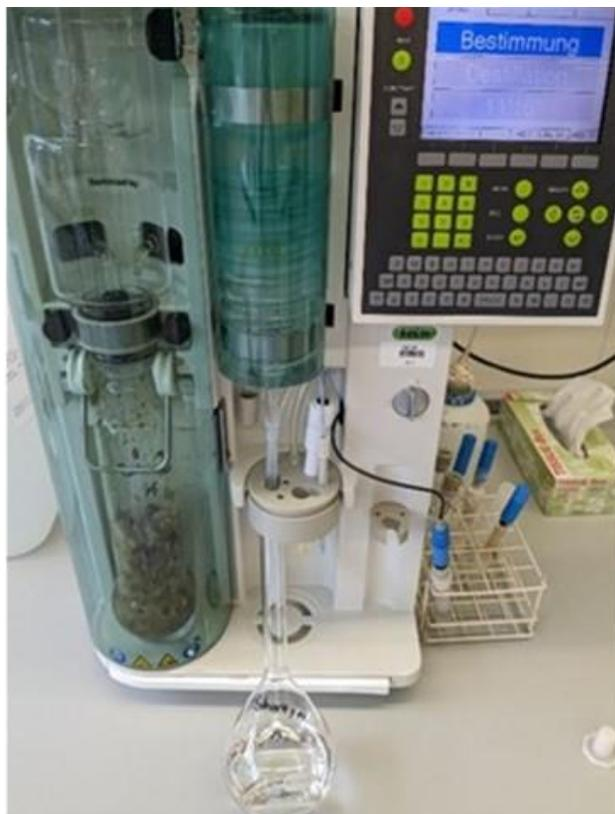
Bild 9: Wasserdampfdestillation zur Extraktentfernung.
