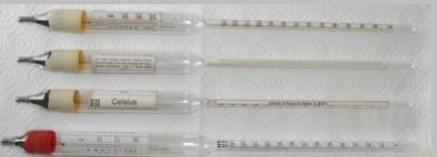
Kalibration der Refraktometer und Spindeln: Dies kann mit Zuckerlösung oder Apfelsaft erfolgen.
