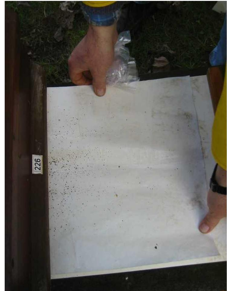
Bodeneinlage mit Öl einsprühen
