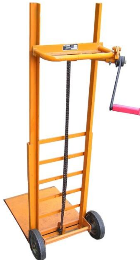
Abbildung 6: Sackkarre mit Kurbel für Kettenhub (Stahlversion)
