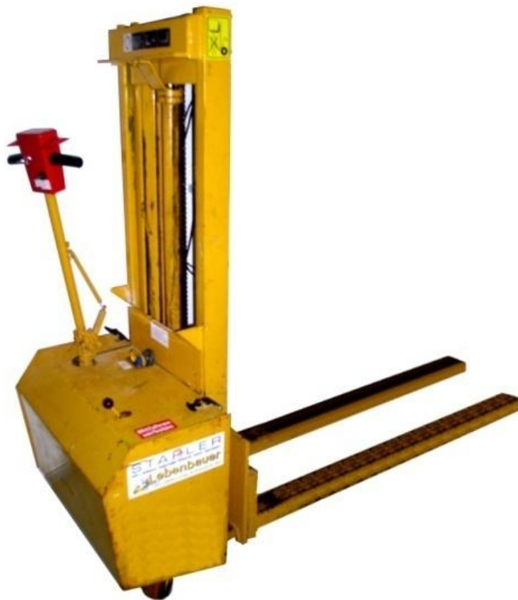
Abbildung 10: Elektrohubwagen mit aufladbaren Batterien
