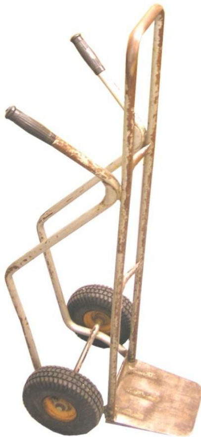
Abbildung 3: Sackkarre (Stahlrohr) geschweißt aus Stahl
