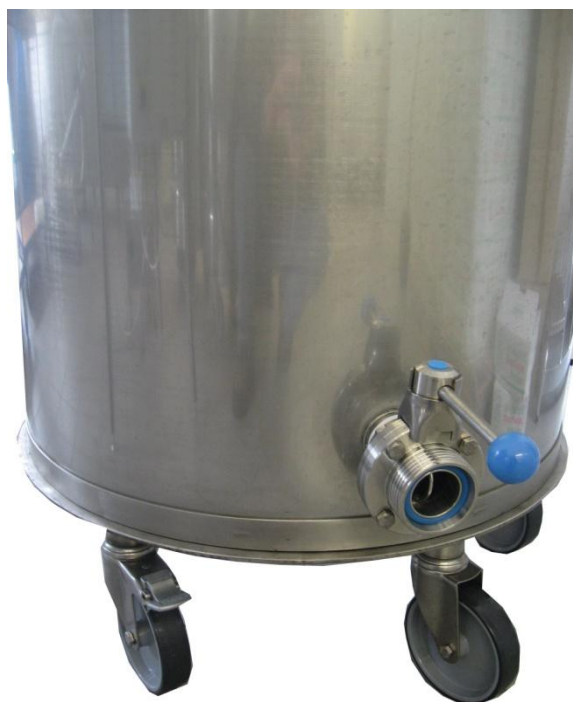
Abbildung 15: Rollsockel im Eigenbau mit 5 Rollen
