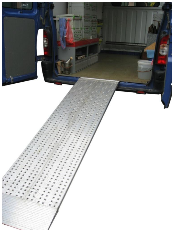
Abbildung 18: Rampe, allmählicher Anstieg mit rutschfestem Halt
