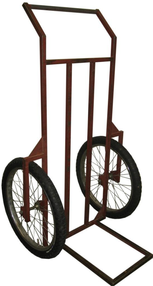
Abbildung 4: Beutenkarre für unwegsames Gelände
