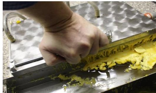
Das Wachs muss nun etwa 30 Sekunden abkühlen. Eine zu lange Abkühlung erhöht die Bruchgefahr bei der Entnahme. Zu heiße Wachsplatten lassen sich nicht aus der Form entnehmen. Die Zeitdauer kann in Abhängigkeit der Wassertemperatur, der Durchflussmenge und der Gussform etwas variieren.
