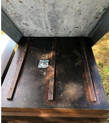
Abb. 2A: iButton direkt unterhalb des Blechdeckels.
