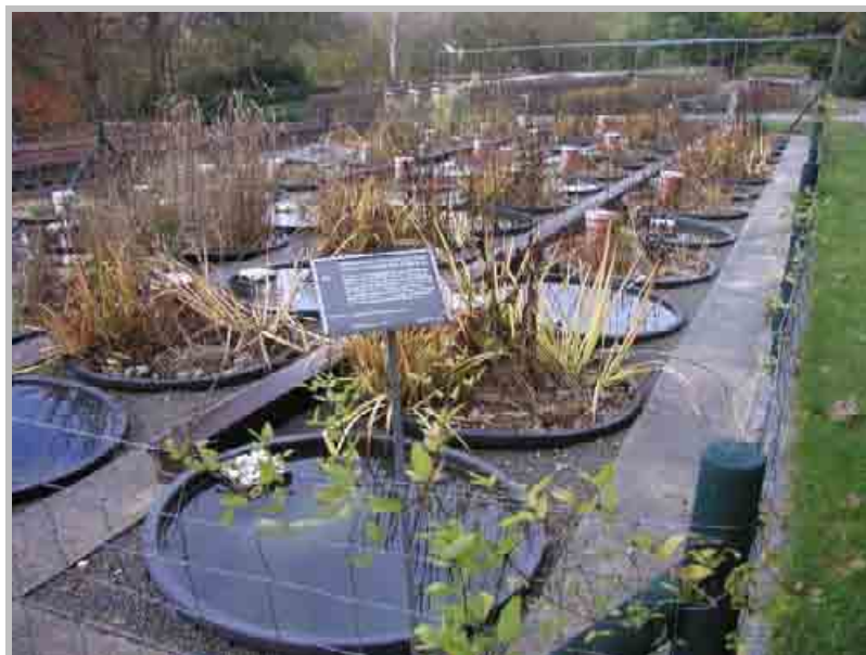
Der Blick über die Versuchsanlage belegt das unterschiedliche Pflanzenwachstum bei den Bodenfiltern
