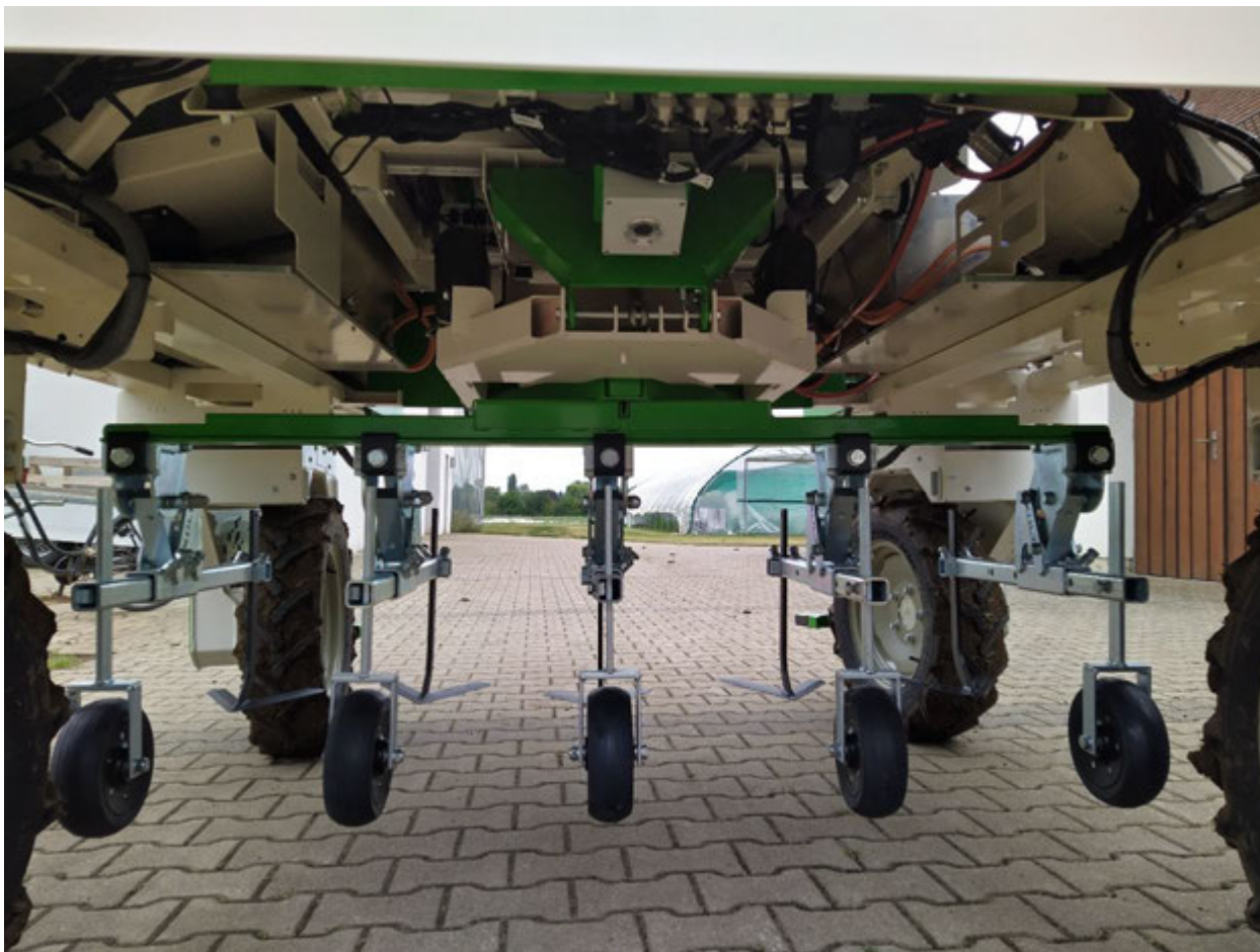
Bild 15: Fest verbauter Werkzeugträger mit einzeln abnehmbaren Parallelogrammen
