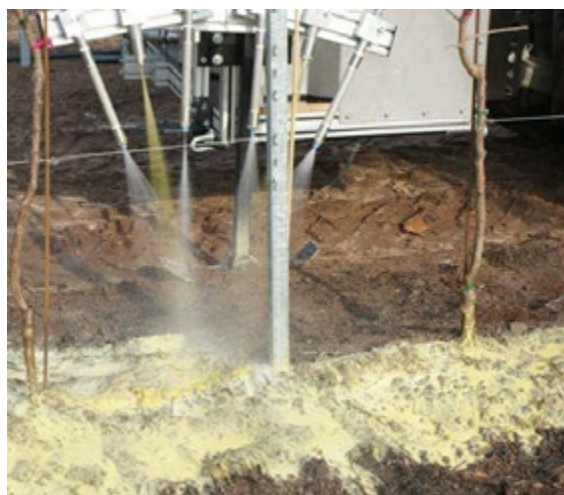
Bild 4: Ausbringung des Zweikomponenten Sprühmulchs
