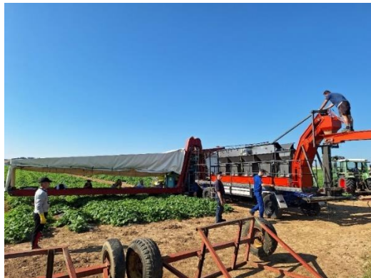
Bild 1: Neu entwickelte mobile Wiege- und Sortiereinrichtung im Einsatz auf der Versuchsfläche
