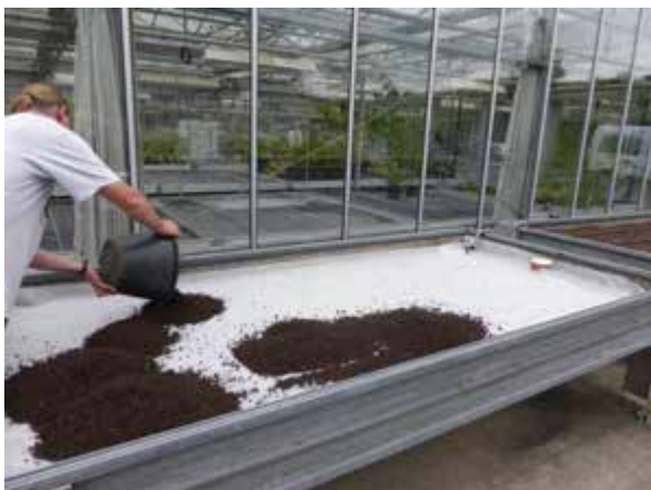
Bild 3: Befüllen des Dachsubstrats auf einem Dachmodell
