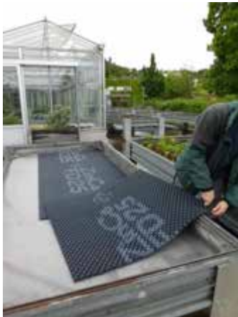
Bild 5: Ausstattung eines Dachmodells mit 25 mm Drainagematte
