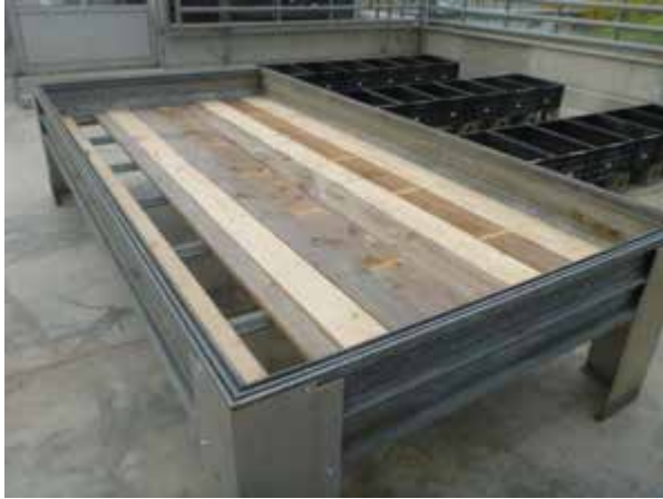
Bild 1 Dachmodell mit Holzbrettern
