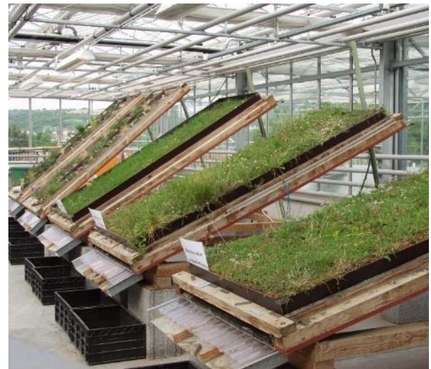
Bild 2: Wie viel Abfluss erzeugt eine Schrägdachbegrünung?
