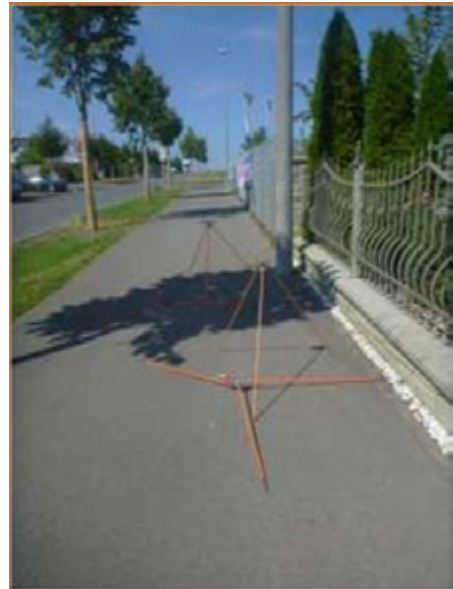
Abbildung 2. Lufttemperaturunterschiede zwischen einer besonnten und einer benachbarten vom Baum beschatteten Asphaltfläche am 29.8.2015 in Würzburg
