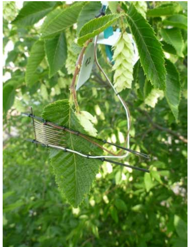
Bild 2: Blatttemperaturmessung im Kronenbereich der Hopfenbuche
