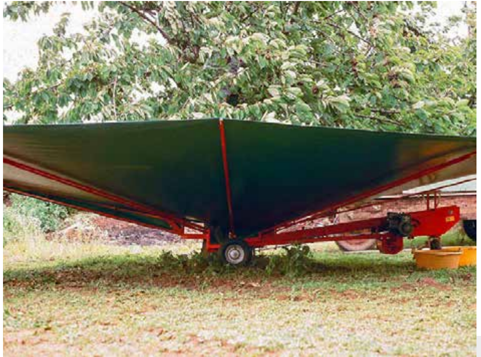
Bild 10: Der Auffangschirm von Harter wird z.B. bei der Kirschenenernte für die Verarbeitung eingesetzt.
