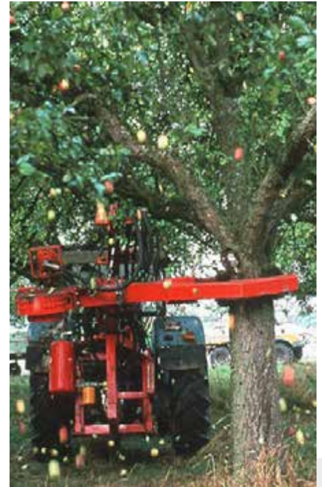
Bild 9: Der Hydraulikschüttler HSA-10 ist außerordentlich effektiv.
