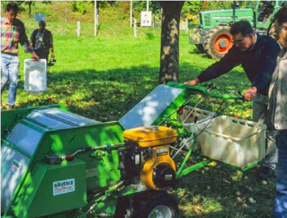
Bild 8: Obstwiesel OW 85 von Bäuerle bei einer Vorführung; das Obst wird in Kisten weggetragen.
