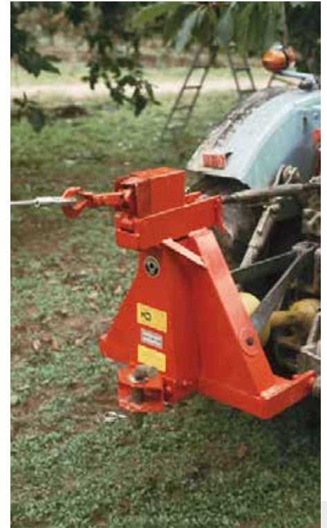
Bild 2: Der Seilschüttler von Harter, am Heck des Schleppers angebaut.
