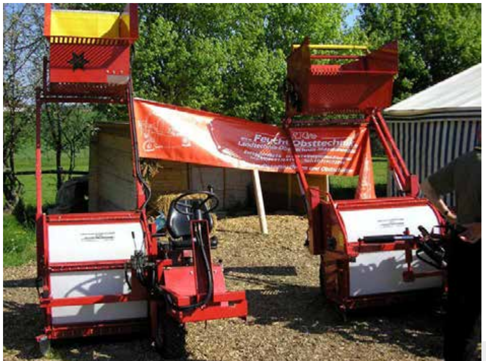
Bild 11: Die Aufsitzgeräte OB 80R (links) und OB 100 A von Feucht können den Bunkerinhalt auf den Hänger kippen, Entladehöhe bis 2,65m.
