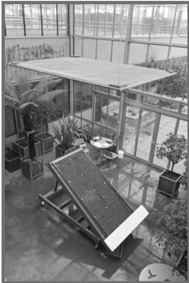
Bild 2: Regensimulation am Böschungsmodell.
