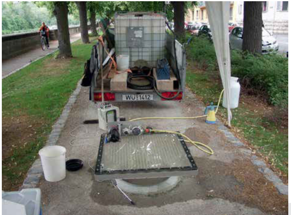
Bild 3: Messung der Wasserdurchlässigkeit mit dem Tropfinfiltrimeter vor Ort zur Abklärung einer der Versuchsfragen: Wie viel Wasser kann der Belag über die Jahre noch aufnehmen? Antwort: So gut wie keines!
