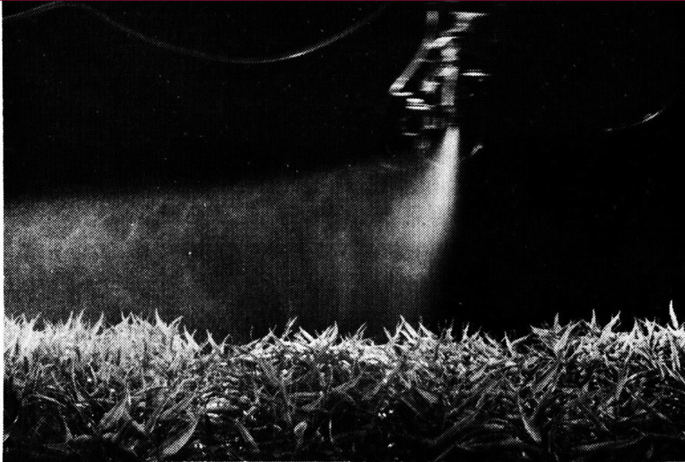
**Bild 2.** Strahlbild mit Strahlschleppe für Teejet 11003 bei 5 bar Spritzdruck und 10 km/h Fahrgeschwindigkeit (Höhe über Bestand 50 cm)
