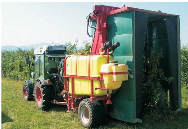
Tunnelspritzgerät im Obstbau zur Abtriftreduktion und Pflanzenschutzmitteleinsparung
