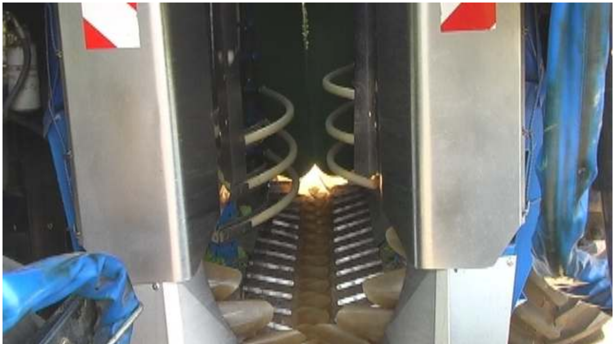
Bild 1: Schwingelemente beim umgerüsteten Traubenvollernter zur Teilentfruchtung von Naturwuchs/Minimalschnitlanlagen
