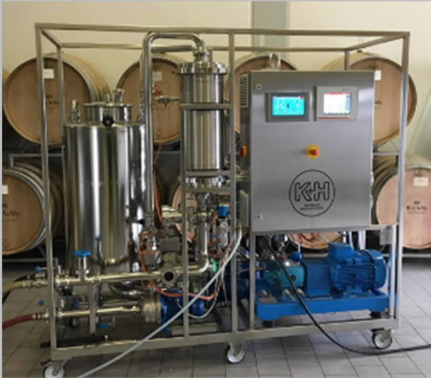
Bild 1 zeigt einen Membrankontaktor der Firma KH-TEC, Quelle: A.Blank, KH-TEC
