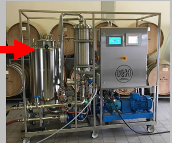
Bild 5 zeigt einen Membrankontaktor der Firma KH-TEC, Quelle: A.Blank, KH-TEC
